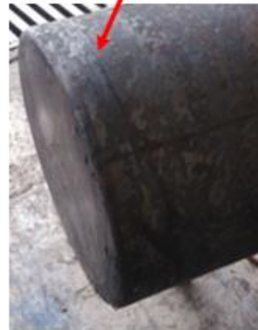
Figura 4: Trincas após têmpera em cilindro de diâmetro de 6 ½”.
