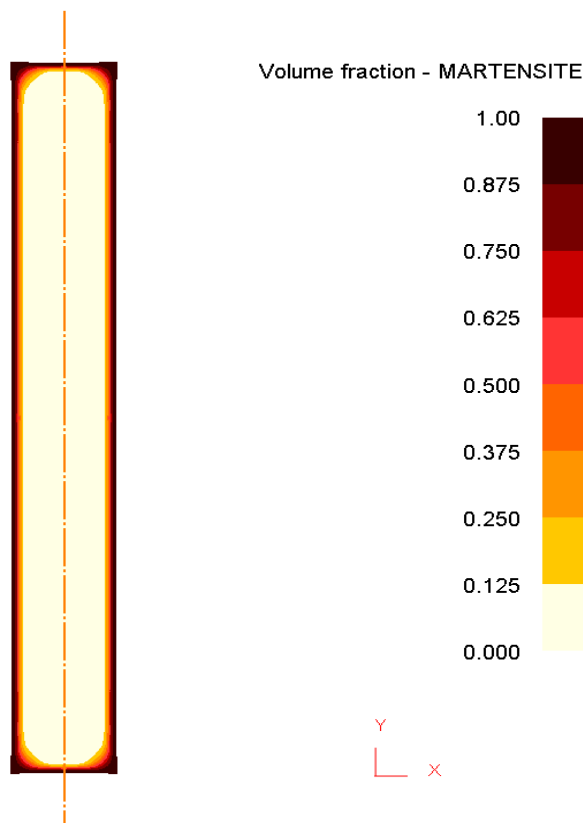
Figura 5: Fração volumétrica de martensita após têmpera em água, em cilindro com diâmetro de 6 ½”.
